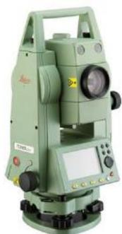
Stazione Totale utilizzata per il rilievo
