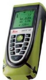
Distanziometro laser utilizzato per il rilievo
