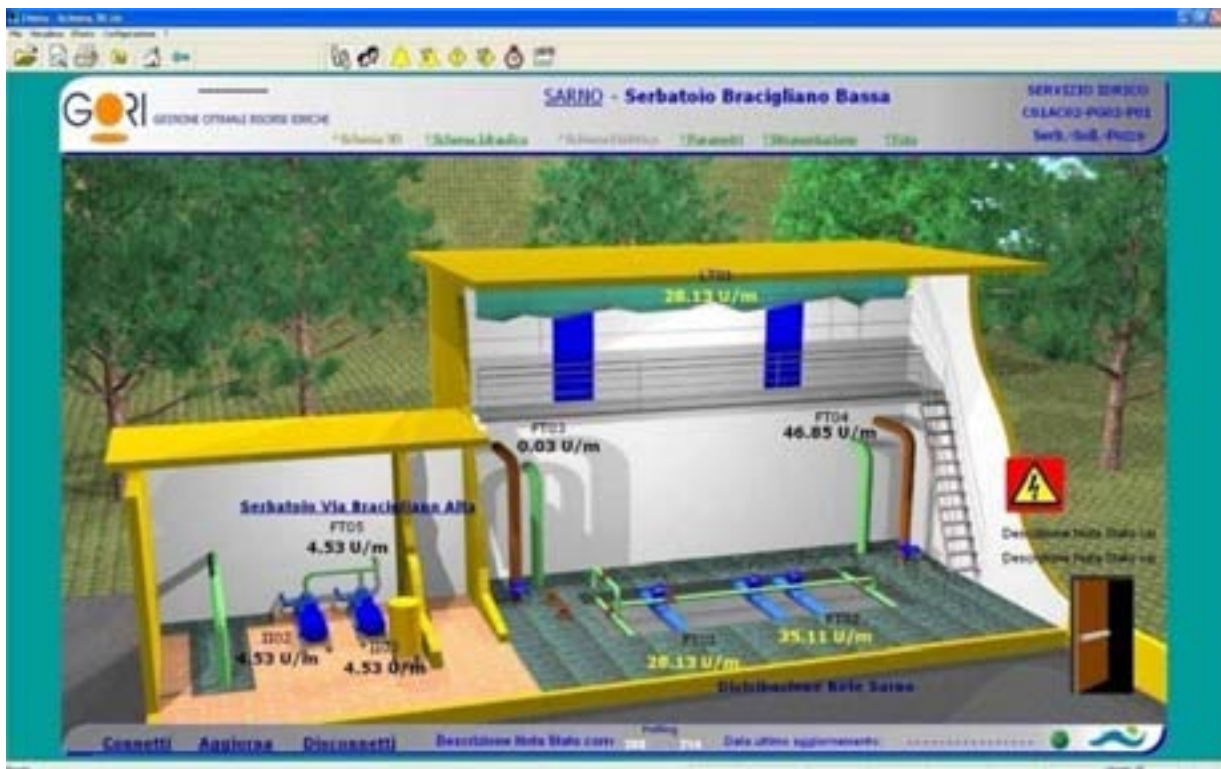
Figura 5 - Pagina sinottica di un Sistema di Telecontrollo
