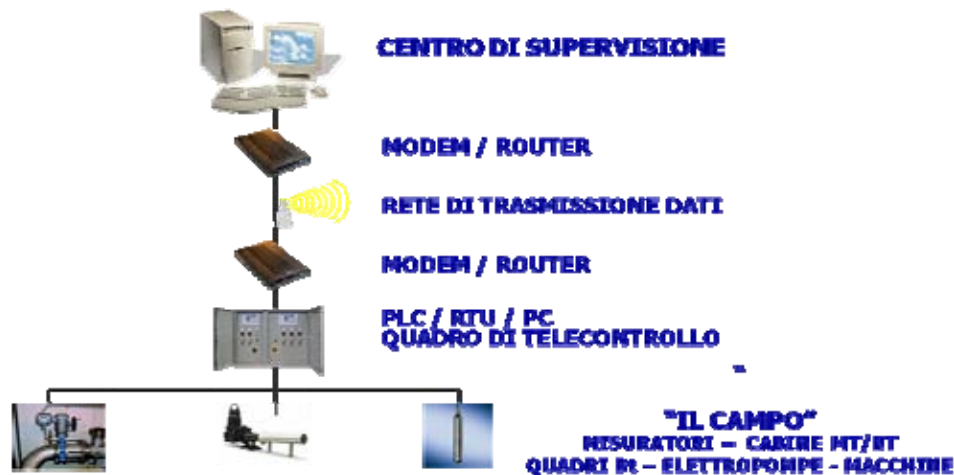
Figura 2 - Architettura classica di un sistema di telecontrollo
