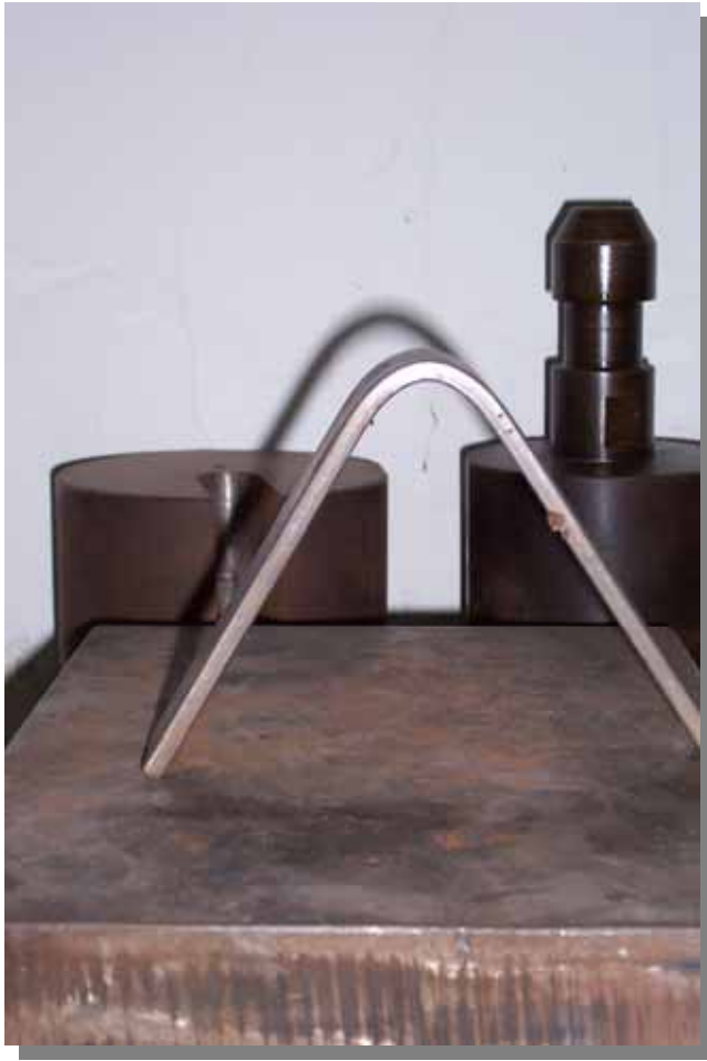
Prova di piegamento
